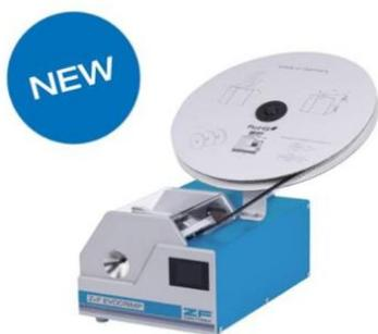
Le modèle EVOCRIMP est une machine électrique de dénudage et de sertissage pour les embouts isolés en bande. Elle possède un écran digital. Economique, fiable et robuste, elle traite des embouts en bande Z+F de 0,5 à 2,5 mm<sup>2</sup> (AWG 20 - 14)
