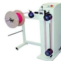
**Z+F : EVOCRIMP - Machine de dénudage & sertissage pour embouts en bande**
