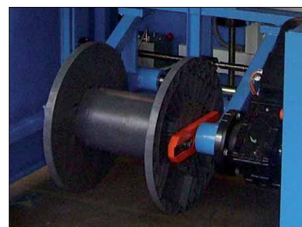
Fig. 4 UMROL 1000 AUF drum reception via spindle sleeves
