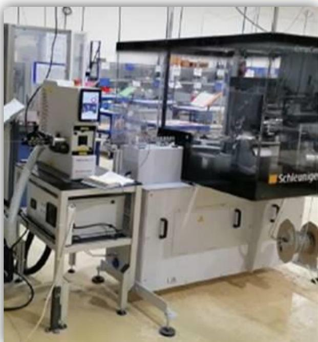
LINTECH, à travers son savoir-faire a intégré en ligne, un laser de dénudage MERCURY 4 sur un automate de haute production CC36S, dans le cadre d'une demande client pour le dénudage et le sertissage de fils gainés en fibre de verre.
