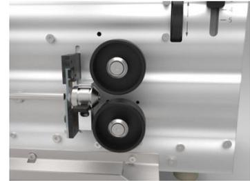
**GLW : MC40 / MC40L, machine de dénudage et sertissage pour la pose d'embouts préisolés en toute simplicité**
